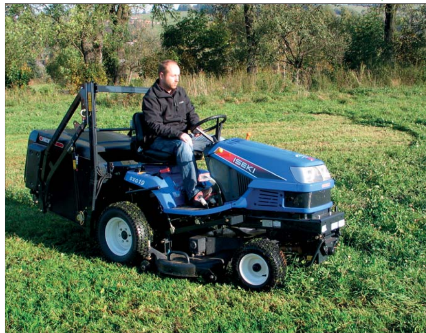
Model ISEKI SXG 19 pracuje se záběrem 1,22 m, koš má kapacitu 550 litrů
