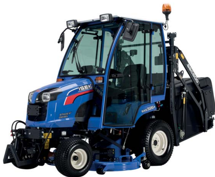
Žací traktor SXG 326+ disponuje větší kapacitou sběracího koše, nový motor splňuje emisní normu Stage V
