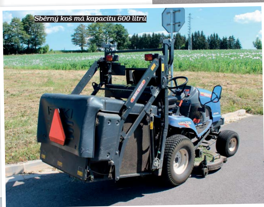
Sběrný koš je hydraulicky výškově vyklápělný až do výšky 1,97 m
