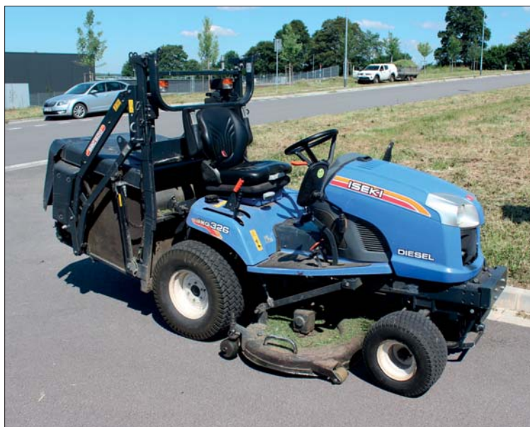
Pohonnou jednotkou žacího stroje Iseki SXG 326 je trvalecový diesellový motor s výkonem 27 koní
