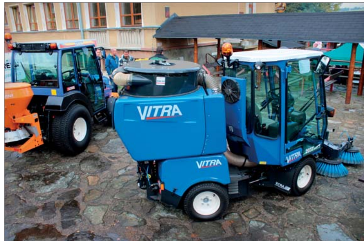
Nosič se může v agregaci s příslušnou nástavbou velice dobře uplatnit jako samosběrný zemetací stroj (ilustrační foto)
