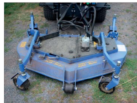
Kromě žací hlavy Iseki Mulch – Master využívané při údržbě travnatých ploch patří do výbavy univerzálního nosiče nářadí také zametací kartáč, sněhová radlice a sypač
