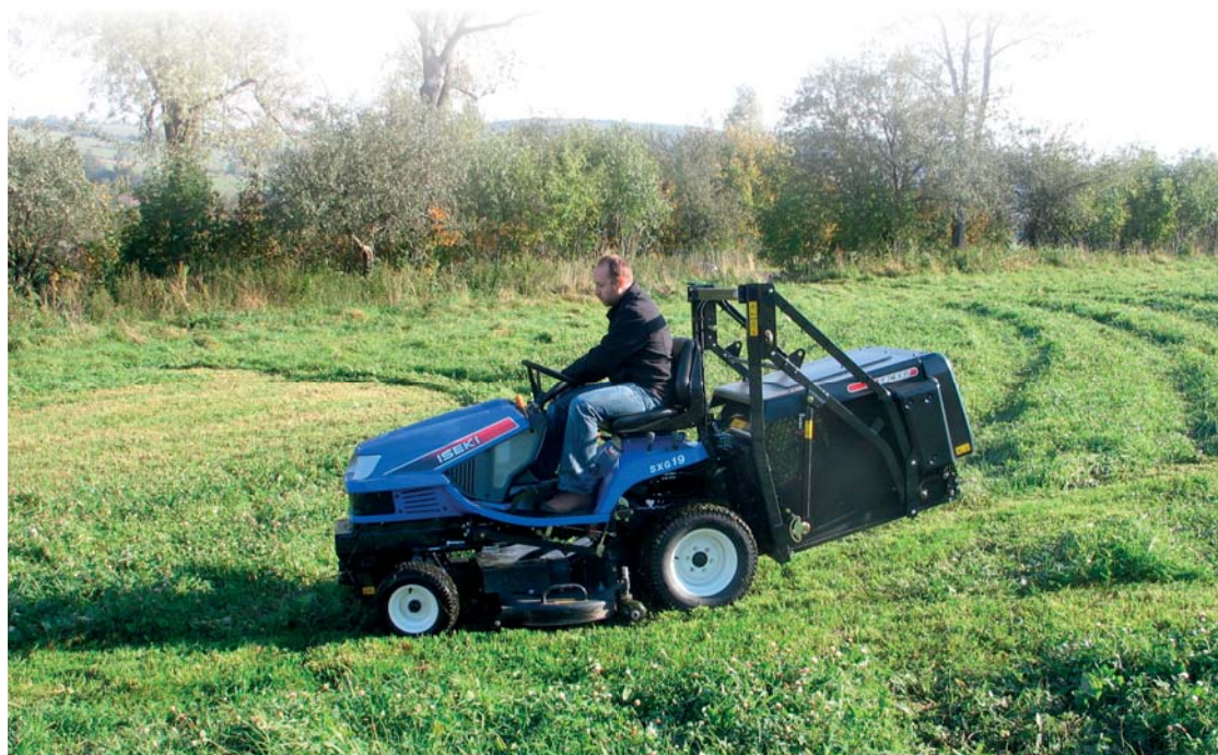
Modely žacích traktorů ISEKI SXG mají plnohodnotný mechanický středový výhoz se dvěma protiběžnými noži
