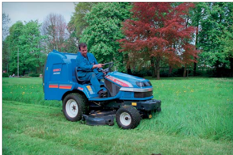
Model ISEKI SGR pracoval se středovým sběrem podpořeným sací turbínou koše s tím, že žací hlava byla tvořena dvěma vlevo se otáčejícími noži po směru hodinových ručiček a jedním pravostranným nožem otáčejícím se proti směru
