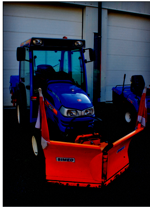
Šikmá kapota zaručuje obsluhu dobrou viditelnost při práci s čelními nástavbami
